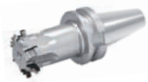
成型铣刀 n=3500r/min fz=0.045mm/z
