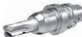
底铣铰刀 n=4000r/min fz=0.03mm/z
