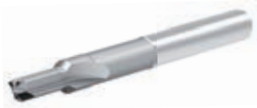
钻铰刀 n=4500r/min fz=0.05mm/z
