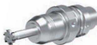
三面刃铣刀 n=6000r/min fz=0.03mm/z
