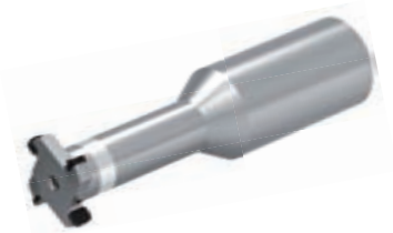
三面刃铣刀 n=8000r/min fz=0.065mm/z
