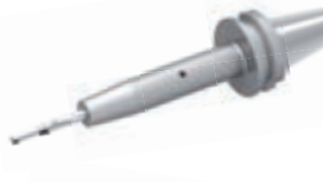
深孔钻铰刀 n=3500r/min fz=0.012mm/z
