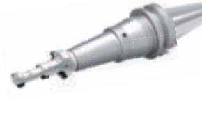
阶梯钻铰刀 n=3750r/min fz=0.025mm/z
