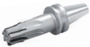
侧面铣刀 n=4000r/min fz=0.055mm/z
