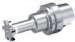
反铣刀 n=8000r/min fz=0.05mm/z
