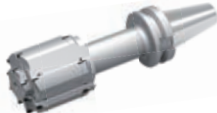
密齿多阶梯铰刀 n=8000r/min fz=0.05mm/z
