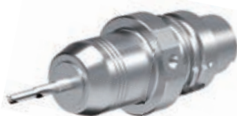
阶梯钻铰刀 n=4000r/min fz=0.04mm/z
