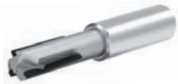
侧面铣刀 n=39800r/min fz=0.10mm/z
