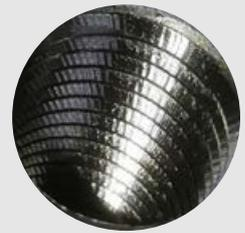
不带 DeVibe“威震”技术的 TC620 Supreme (致强) 刀具在加工中产生了很强的振动。
